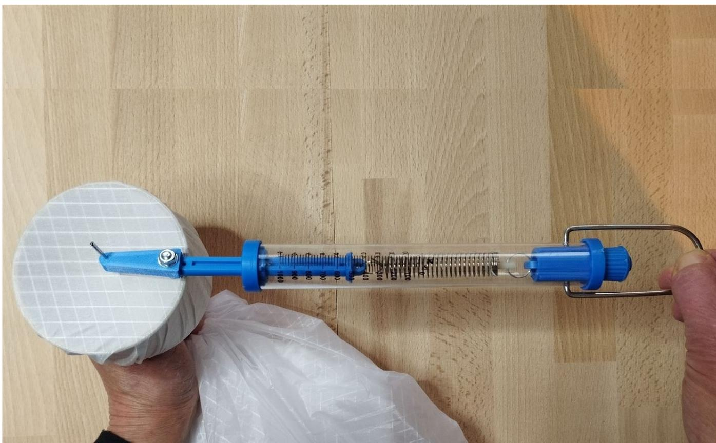
Im privaten Gebrauch ersetzt die Messung der Reißfestigkeit natürlich nicht den vorgeschriebenen Service bzw. Check eures Schirms. Der Schirm muss gemäß Herstellerangaben und lokalen Regelungen regelmäßig durch einen autorisierten Checkbetrieb überprüft werden. Dieser überprüft neben der Reißfestigkeit des Tuches auch die Porosität und Beschädigungen des Tuches, sowie die Leinenlängen und deren Bruchlast.
